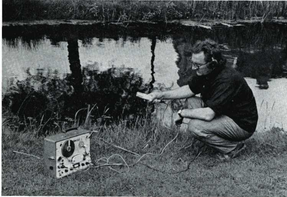
De geluidsopnamen in de natuur ter illustratie van zijn films en dia-series maakt hij met zijn Maihak 19 cm volspoorrecorder met veerwerk. Een professioneel apparaat dat Pieëte zich veroorlooft om de best mogelijke technische kwaliteit te bereiken.
